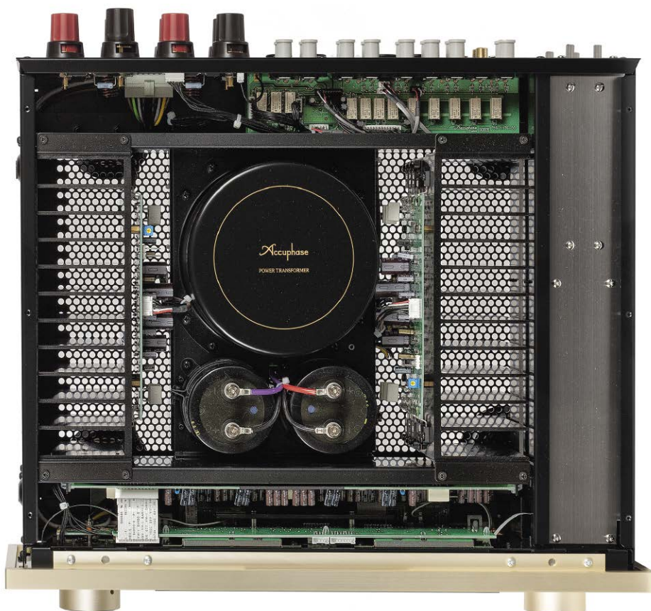
Montaż wszystkich podzespołów jest drobiazgowo staranny, poszczególne sekcje rozdzielono przegrodami, które pełnią również funkcję ekranującą.
